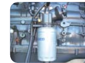
Préfiltre gasoil avec capteur de présence d'eau
